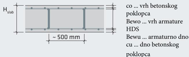
$$\text{visina odstojnika: } H_{DS} = H_{\text{slab}} - (c_o + \text{Bew}_u + \text{Bew}_o + c_o)$$
